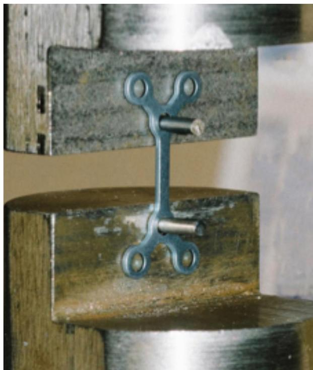
Fig. 5. Miniplaca posicionada para la prueba de tracción. se presenta posición de pasadores y miniplacas en donde el sentido de las fuerzas aplicadas es opuesto entre sí.
