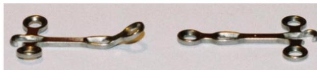
Fig. 11. Comparación de deformación del bisel: a la izquierda miniplaca con bisel libre durante la tracción, a la derecha miniplaca con el bisel fijo.
