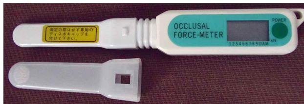
Fig. 1. Dispositivo de presión hidráulico con una cubierta intercambiable e higienizable de polivinilo (GM10, Nagano Keiki, Tokyo, Japón).
