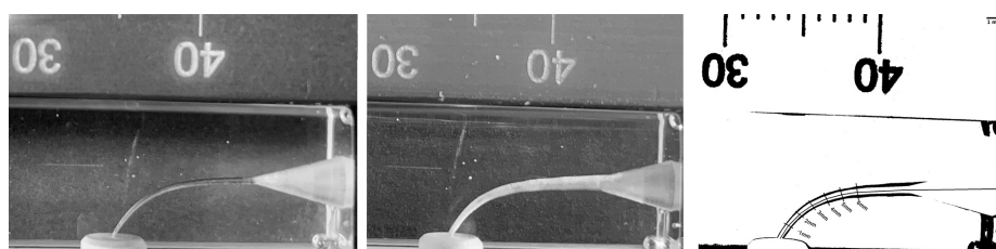
Fig. 2. Canal radicular sin instrumentar (A); Canal radicular post instrumentación (B); Imágenes A y B superpuestas procesadas en ImageJ (C).
