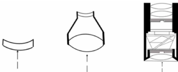
Fig. 1. De izquierda a derecha lupas simple, compuesta y prismática.
